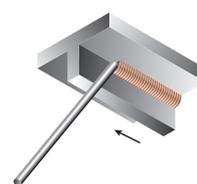
PD SOUDURE D'ANGLE AU PLAFOND
