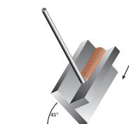
PA SOUDURE EN GOUTTIÈRE
